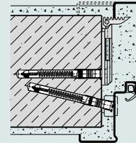
Dübel- und Klappanker- montage (Sichtmauerwerk / Porenbeton)
