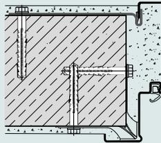
Dübel- und Klappanker- montage (Mauerwerk / Beton)
