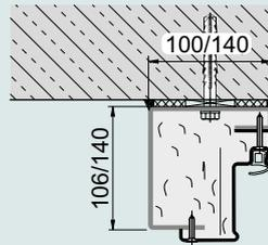
Bauseitige Verschraubung und optional werkseitige Verfüllung
