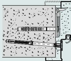
Schweißmontage mit Ankerbügel (Porenbeton)
